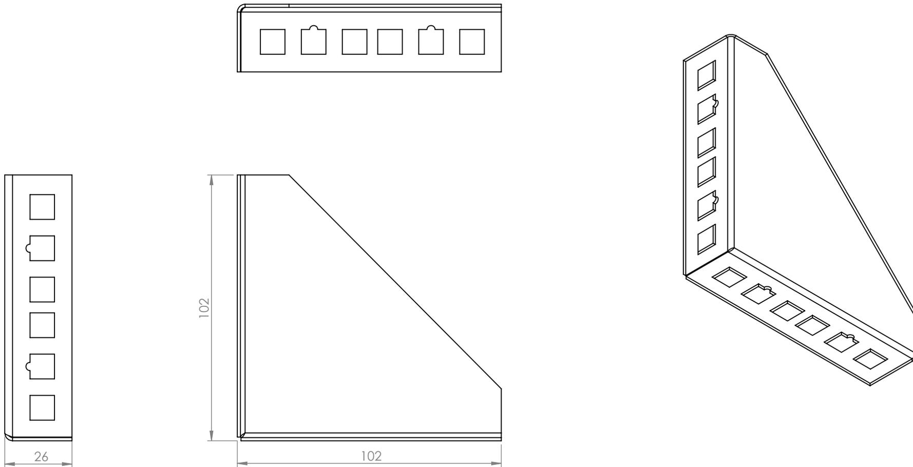
1. Material: Lámina de acero calibre 18.
